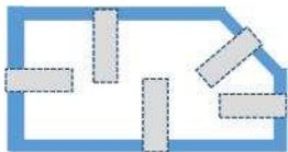
Il tester di trazione è programmato per funzionare ad una velocità di 200 mm/min e registra la forza. La forza deve essere almeno pari a 1,5N per una tenuta di 15mm. Se uno dei sigilli dell'imballaggio è al di sotto di questo limite, l'imballaggio non è conforme.
